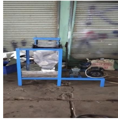
Gambar 4 mesin pemeras tebu sesudah finishing
