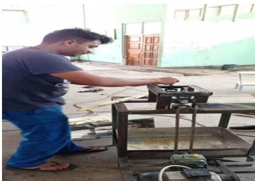
Gambar 3 mesin pemeras tebu sebelum difinishing
