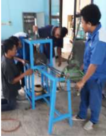
Gambar 11. Uji coba mekanisme Hasil uji coba terhadap komponen terakit, sebagai satu kesatuan didapatkan, engkol dapat bergerak secara rotasi dan alu melakukan gerakan translasi, sebagaimana direncanakan
