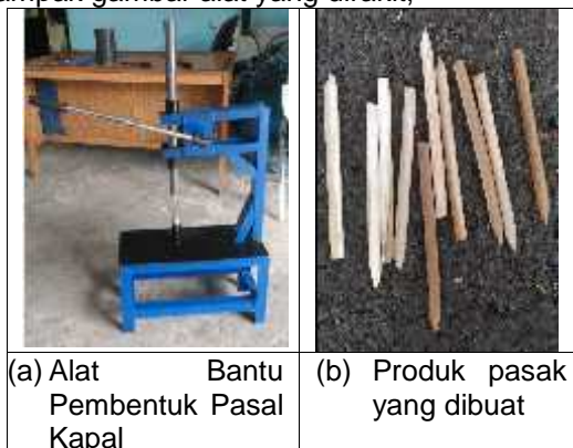
Gambar 18. Alat Bantu Pembentuk Pasak Kapal
