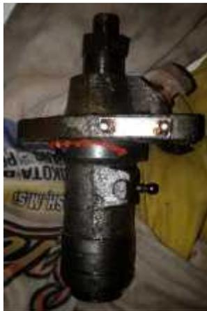
Gambar 4. Pompa injeksi *in-line* silinder tunggal
