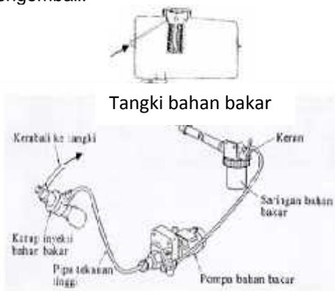
Gambar 3. Skema sistem bahan bakar motor Diesel silinder tunggal
