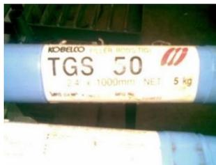
Gambar 11. *Filler Metal* yang Dipakai untuk Pengelasan TIG
