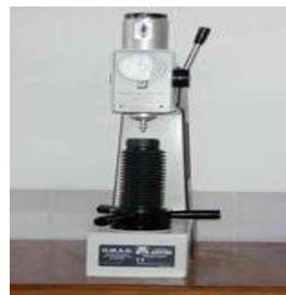
Gambar 13. Alat Uji Kekerasan
