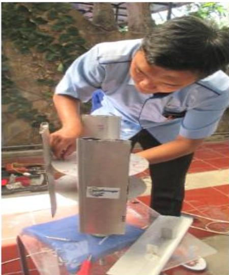
Gambar 5. Ekperimentasi Turbin Angin sumbu Vertikal 4 sudu dengan sudut pitch 00
