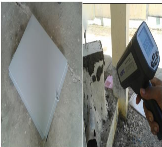
Gambar 2. Penutup Tungku dan Thermocouple tembak laser.
