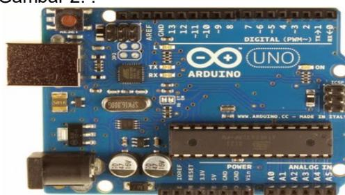
Gambar 2. Bentuk Fisik Arduino Uno R3.
