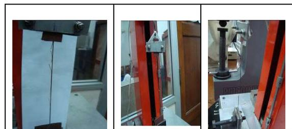
Gambar 4. Proses Pengujian Serat Tunggal
