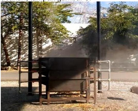
Gambar 5. Alat Pembakaran Tempurung Kelapa Cacahan
