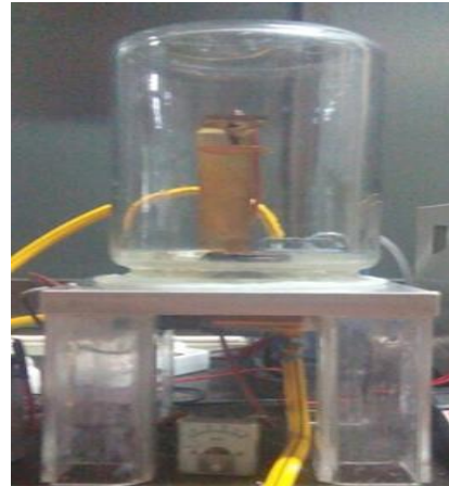
Gambar. 4 Reaktor plasma yang digunakan dalam penelitian.
