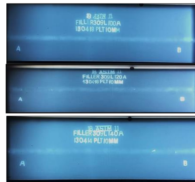
Gambar 7. Hasil Pengujian Radiography Pada Test Coupon (100A, 120A, 140A)
