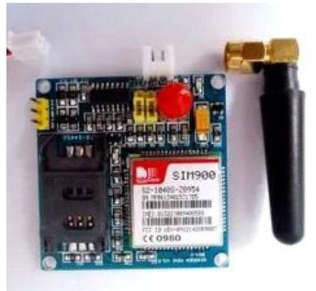
Gambar 5. Modul GSM - SIM900
