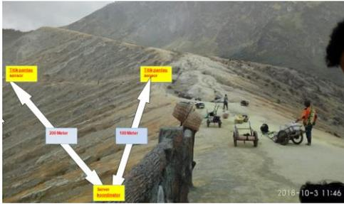
**Gambar 9** titik sensor horizontal dengan server dan koordinator
