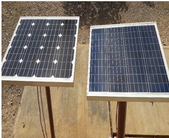
Gambar 5. Modul PV monocrystalline (kiri) dan polycrystalline (Kanan)
