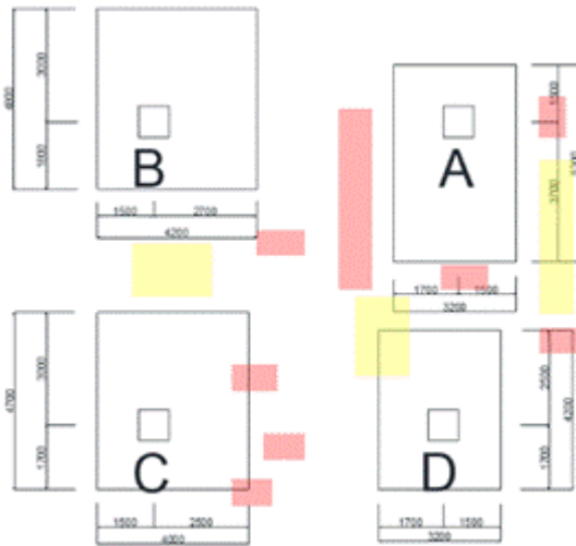
Gambar 7. Dimensi pondasi hasil interpretasi radiogram scan pedestal A ke pedestal D dan indikasi adanya kantung air
