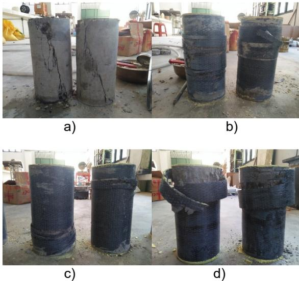
Gambar 6. Kondisi benda uji setelah tes, a) BR-0-0(1&2), b) BR-T-1(1&2), c) BR-T-3(1&2), dan d) BR-W-1(1&2)
