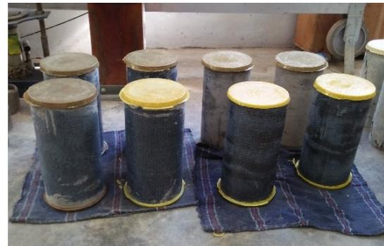
Gambar 5. Benda uji setelah pencappingan
