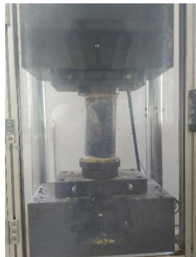
Gambar 7. Kondisi benda uji saat pembebanan(BR-T-1(2))
