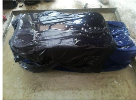
Gambar 4. Perawatan benda uji dengan karung basah
