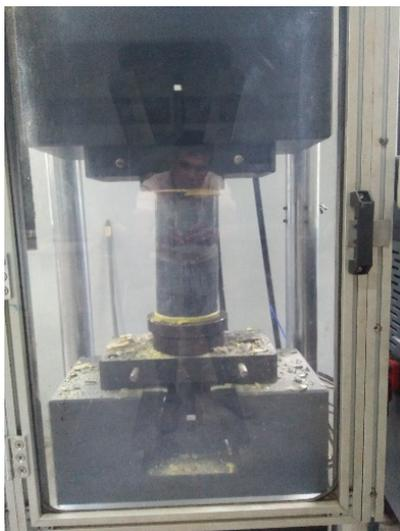
Gambar 8. Kondisi benda uji saat pembebanan (BR-T-3(1&))
