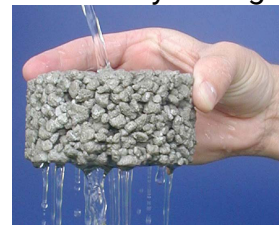
Gambar 2. Karakteristik porositas air dari beton
