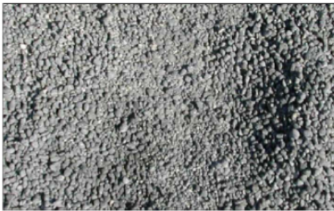
Gambar 6. Adonan dengan kadar air terlampau sedikit, berpotensi raveling
