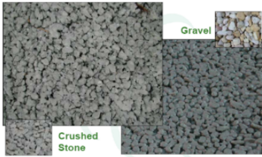
Gambar 5. Agregat hasil pemecahan mekanis dan kerikil alam dengan bentuk permukaan bersudut dapat digunakan sebagai bahan beton porous
